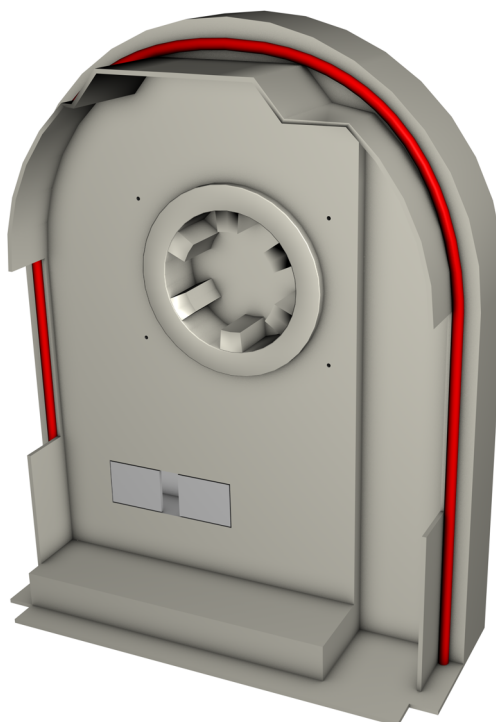
▲ Figure B5 : Exemple de solution de cordon d'étanchéité des joues de coffre tunnel
